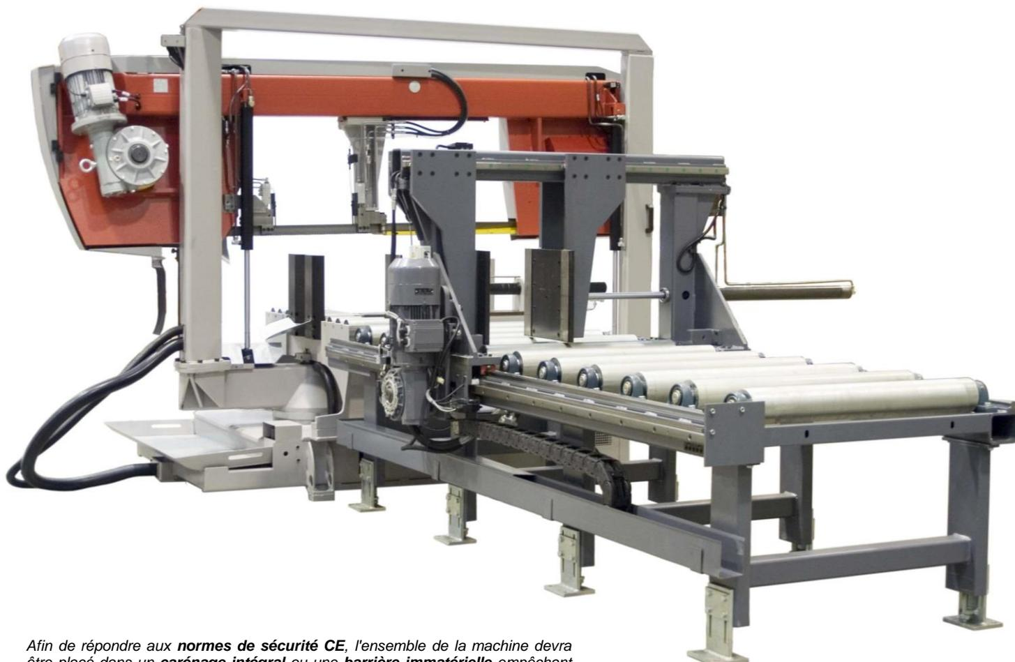
Afin de répondre aux **normes de sécurité CE**, l'ensemble de la machine devra être placé dans un **carénage intégral** ou une **barrière immatérielle** empêchant l'accès aux éléments mobiles (bras de sciage mais également pince d'amenage).
